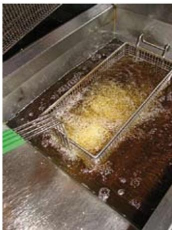
*Figura 9. Fotografía que muestra una freidora en la que empiezan a formarse en la superficie del aceite y en las zonas laterales de la freidora, capas adherentes que resultan muy complicadas de eliminar.*
