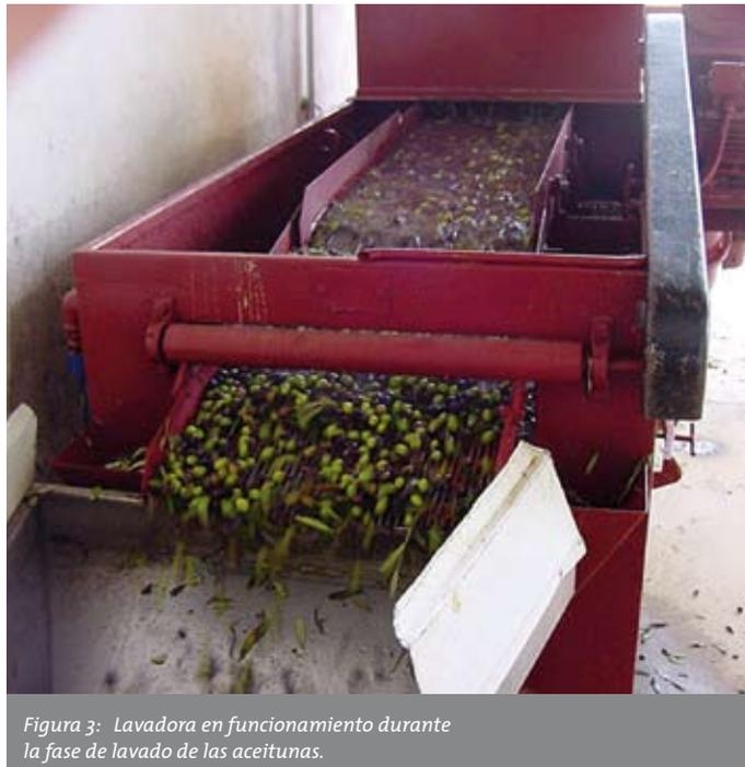
*Figura 3: Lavadora en funcionamiento durante la fase de lavado de las aceitunas.*
