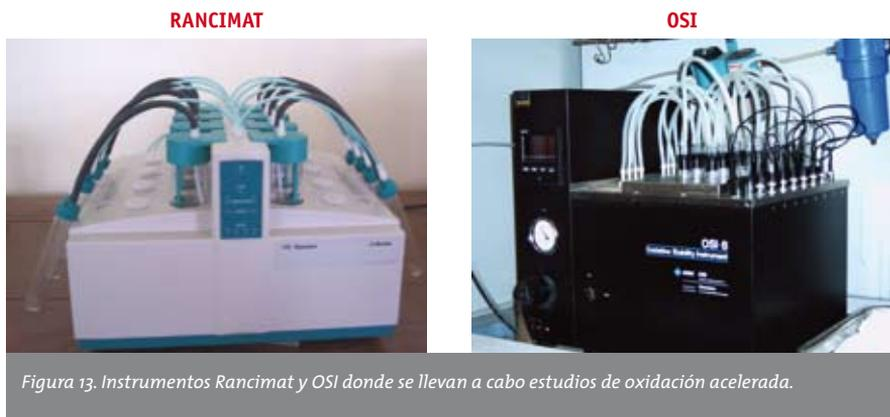
Figura 13. Instrumentos Rancimat y OSI donde se llevan a cabo estudios de oxidación acelerada.
