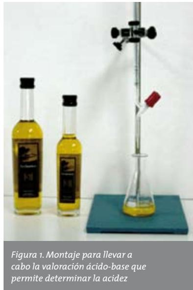
*Figura 1. Montaje para llevar a cabo la valoración ácido-base que permite determinar la acidez*
