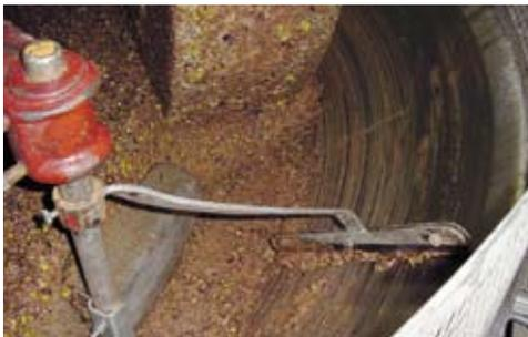
*Figura 4. Molino de piedras. Detalle del interior.*
